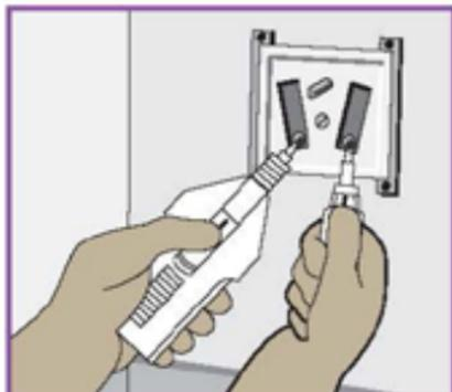
**ATTENTION: en aucun cas, un appareil de mesure ne peut être utilisé pour réaliser une vérification d'absence de tension.**
